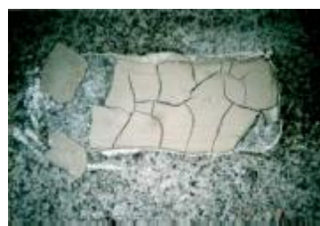
吸着材はひびわれ始めたらはずす 乾燥速度の調整にラップを使用
